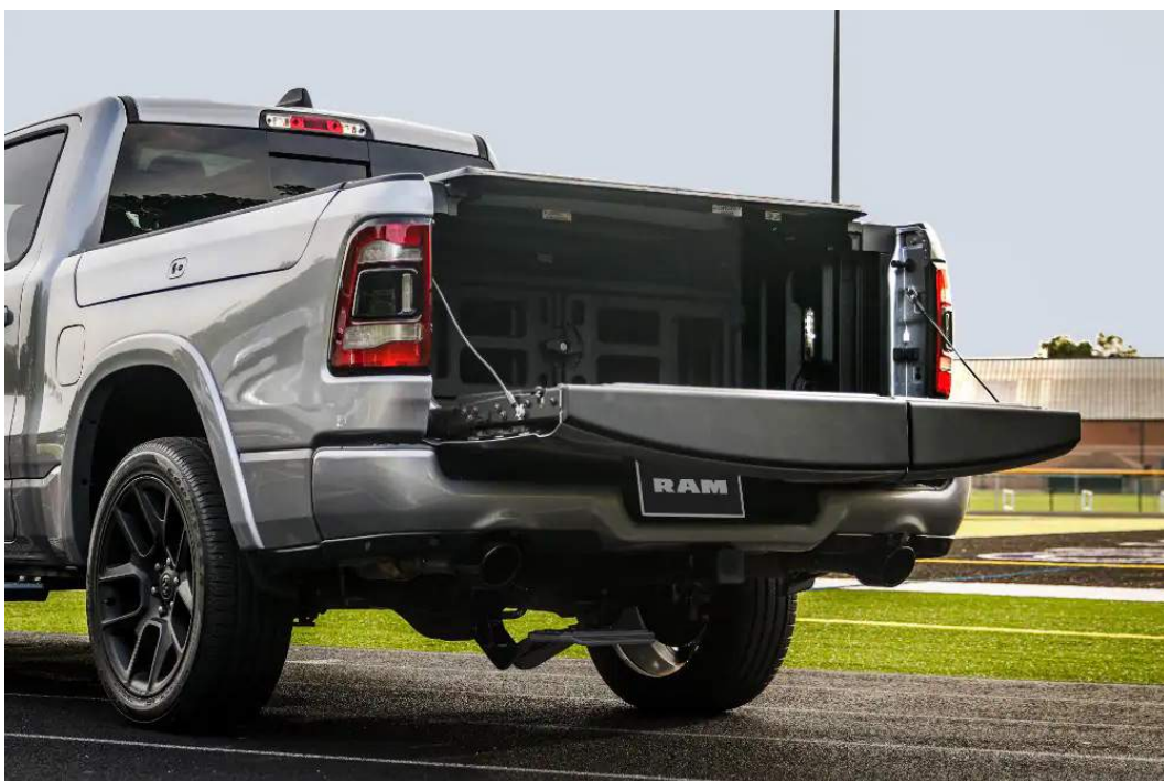
Mwk klep omlaag
